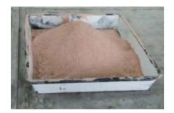
Fig 4 : Granite Slurry
